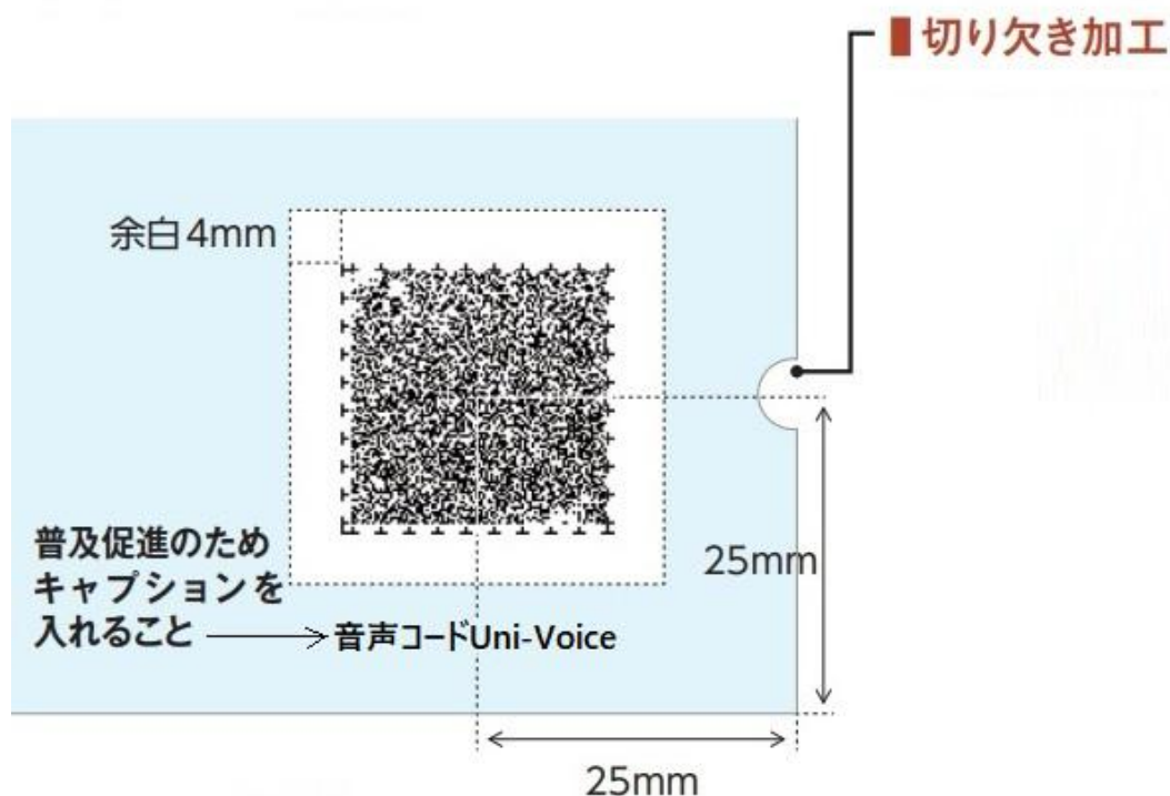
図: 音声コード Uni-Voice の印刷位置と切り欠きのサイズと位置
